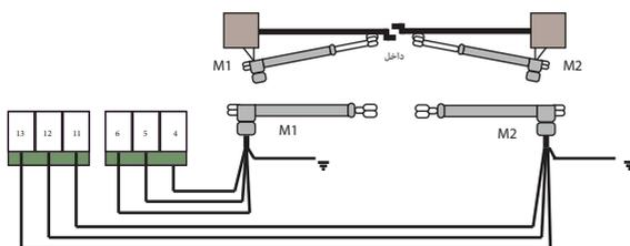
در کورس باز شدن، ابتدا موتور یک (M1) شروع به باز شدن کرده و پس از گذشت تأخیر تعیین شده، موتور دو (M2) شروع به باز شدن می‌کند.
