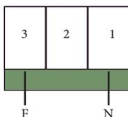
برق شهری (220VAC/50HZ) را به ترمینال های F و N مرکز کنترل متصل نمایید. پیشنهاد می‌شود یک فیوز مینیاتوری قبل از ولتاژ ورودی به مرکز کنترل تعبیه نمایید و همچنین حتما سیم ارت دستگاه وصل شود.
